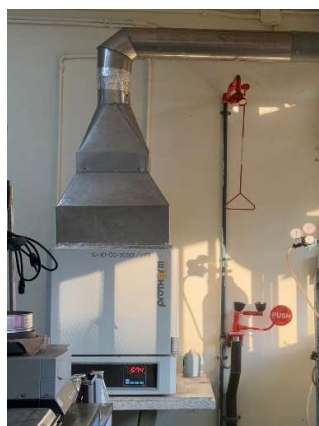
เผาและกระตุ้นไม้ ซังข้าวโพด และผสมที่อุณหภูมิ
