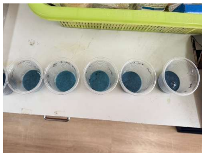
ทดสอบการดูดซับโลหะหนักทองแดง ของถ่านกัมมันต์แต่ละชนิด
