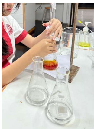
ตรวจสอบความหนาแน่น และค่าไอโอดีนัมเบอร์ ของถ่านกัมมันต์แต่ละชนิด
