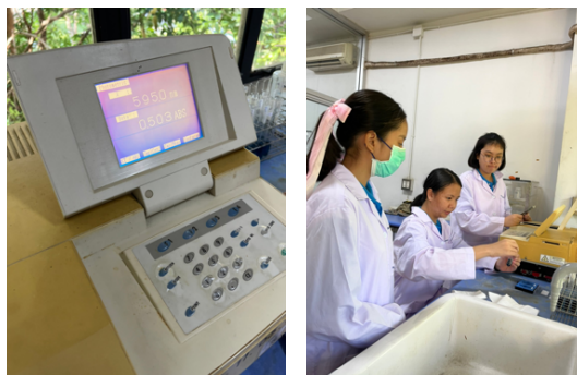
นำสารตัวอย่างที่ได้เทใส่ใน cuvette แล้วนำเข้าเครื่อง UV-visible spectrophotometer ความยาวคลื่น 595 nm
