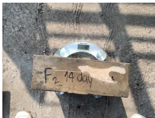
ภาพ 2.4.3 การชั่งน้ำหนักคอนกรีตบล็อกด้วยเครื่องชั่งน้ำหนักแบบดิจิตอล
