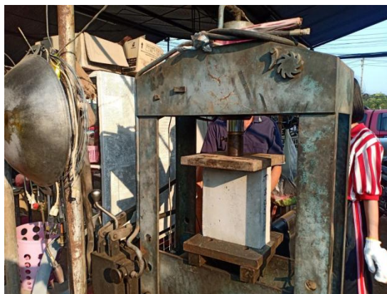
ภาพ 2.3.2 การใช้เครื่องทดสอบแรงอัดแบบหน้าปัด
