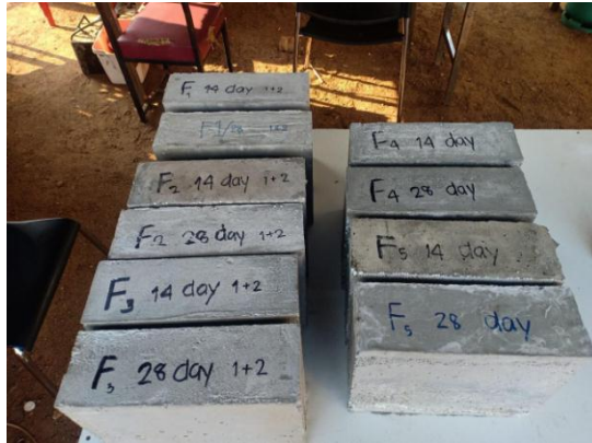
ภาพ 2.3.1 คอนกรีตบล็อกแต่ละสูตรที่ใช้ทำการทดสอบกำลังรับแรงอัด
