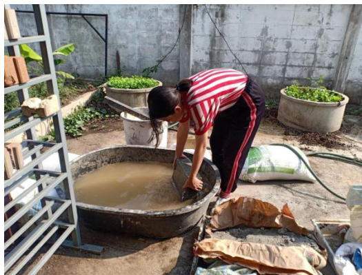
ภาพ 2.4.2 นำคอนกรีตบล็อกมาชั่งหน่วยน้ำหนักหลังแช่น้ำ
