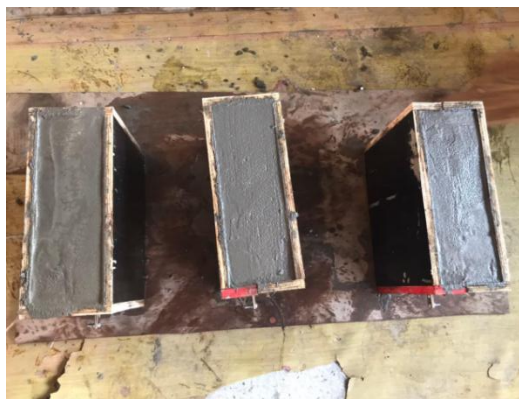
ภาพ 2.1.5 เทส่วนผสมคอนกรีตลงในบล็อกขึ้นรูปที่มีการจัดวางขวดพลาสติก PET
