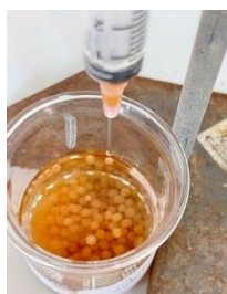
ภาพของการทำเม็ดเงินและภาพเม็ดเงินในกล้องจุลทรรศน์ 3 มิติ แบบใช้แสง
