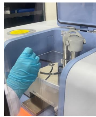
การวิเคราะห์หมู่ฟังก์ชันด้วย เครื่อง FT-IR
