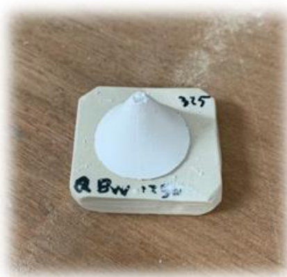
รูปที่ 3.2 ซิลิกาอสังฐานหลังเผาที่อุณหภูมิ 1,250 องศาเซลเซียส
