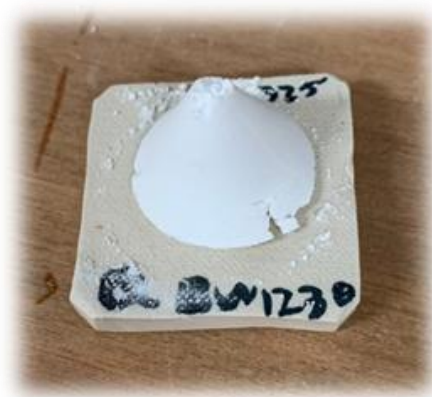
รูปที่ 3.1 ซิลิกาอสังฐานหลังเผาที่อุณหภูมิ 1,230 องศาเซลเซียส
