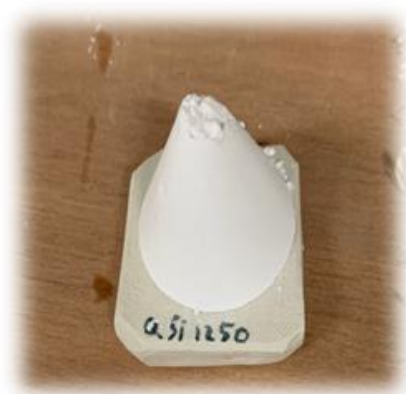
รูปที่ 3.4 ซิลิกาผลึกหลังเผาที่อุณหภูมิ 1,250 องศาเซลเซียส
