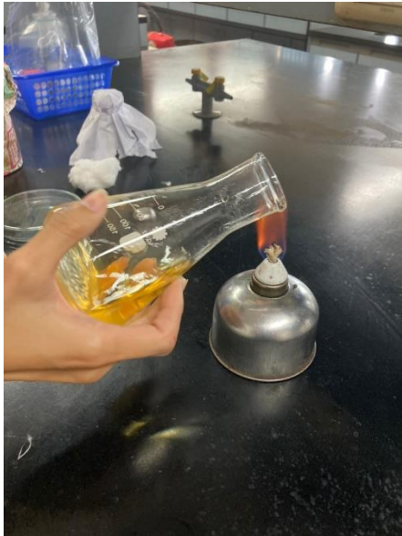
รูปที่ 17 นำปากขวด Flask ไปร่นไฟ
