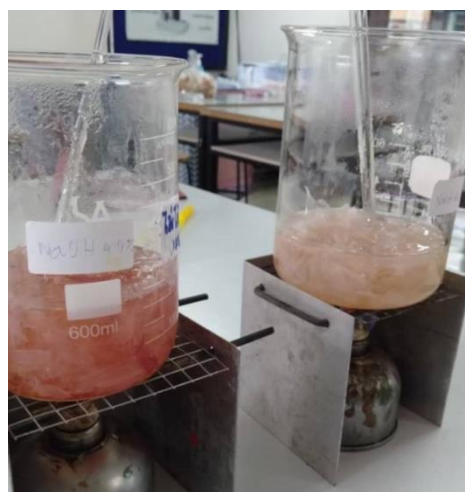
ภาพที่ 4 การสกัดสารสกัดหยาบจากไคโตซานจากเปลือกกุ้ง
