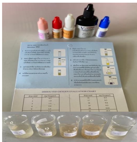
ภาพที่ 6 เตรียมการทดสอบประสิทธิภาพสารสกัดหยาดจากไคโตซานเพื่อบำบัดน้ำเสีย
