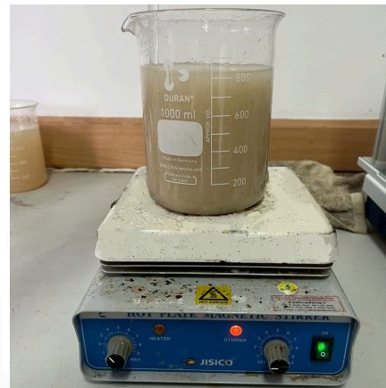
ต้มบน Hot plate ที่ 95 องศาเซลเซียส เป็นเวลา 30 นาที
